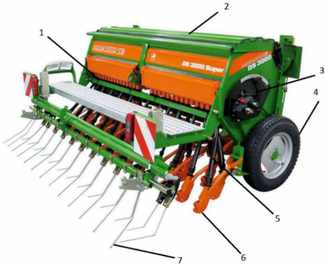
Рисунок 1.5 - Навісна механічна сівалка Amazone D9: 1 - висівальний апарат, 2 - насіннєвий бункер, 3 - варіатор, 4 - опорно-привідне колесо, 5 - семяпровод, 6 - сошник, 7 - загортач «Ехакт»
