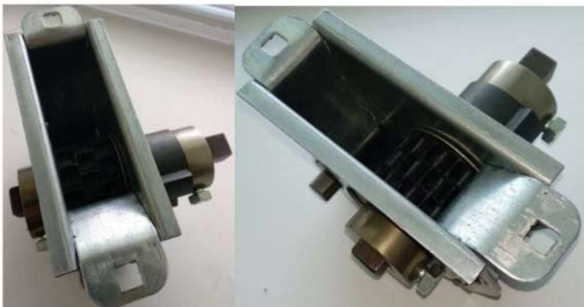
Рисунок 3.6 – Загальний вигляд катушкового висівного апарату з чотирьохсекційною катушкою, жолобки якої виконані у формі частини тора
