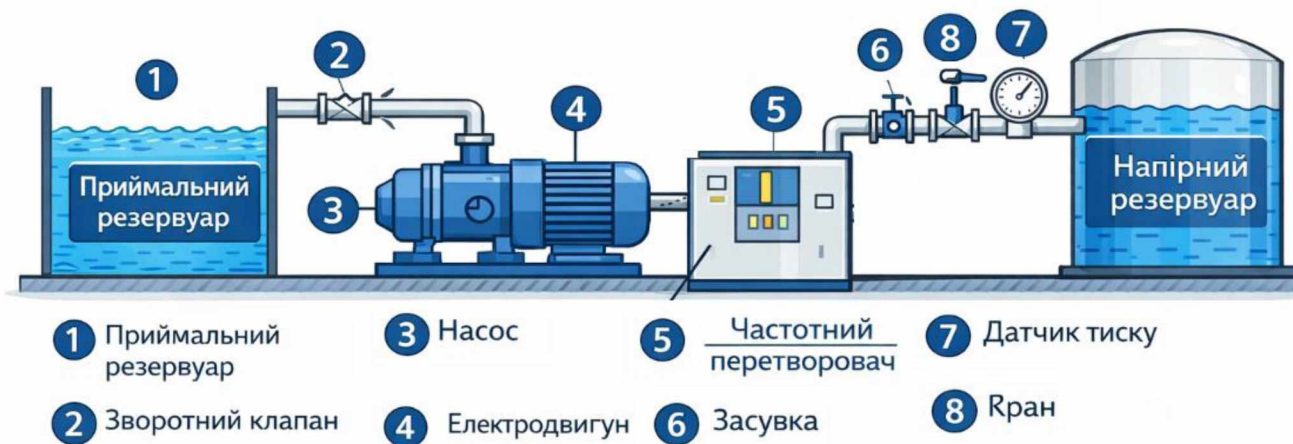
Рисунок 2.1. Структурна схема насосної установки.
