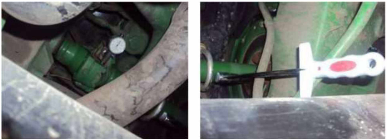
Рисунок 2.4 – Схема установки приладу на карданний вал
