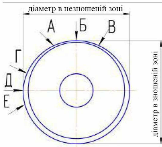
Рисунок 2.1 – Схема вимірювання шипа хрестовини
