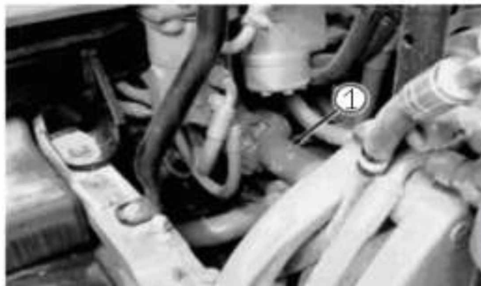
Рисунок 1.3 – Загальний вигляд і розташування карданного валу приводу «двигун – коробка передач»
