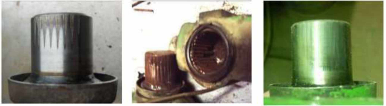
а) втомне викришування б) помилкове брінелювання в) абразивний знос
