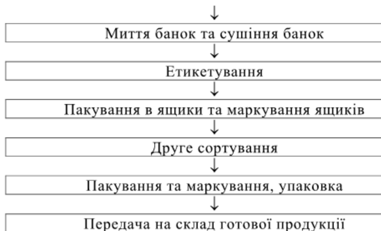
Рисунок 3.1 – Діаграма процесу виробництва консервів «Яловичина тушкована» І гатунок, «Свинина тушкована» вищій гатунок
