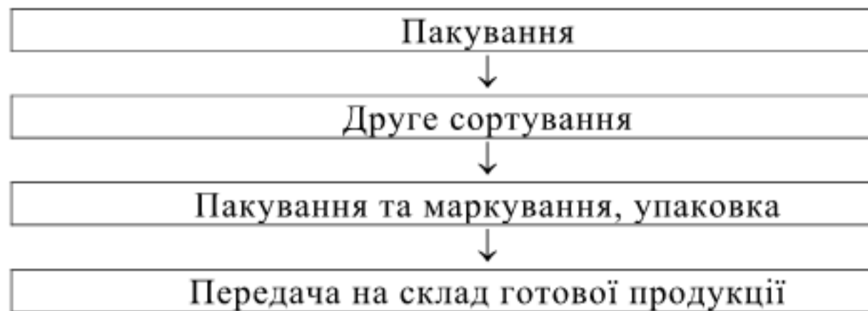
Рисунок А.1 – Технологічна схема виготовлення консервів «Фарш Дніпровський»
