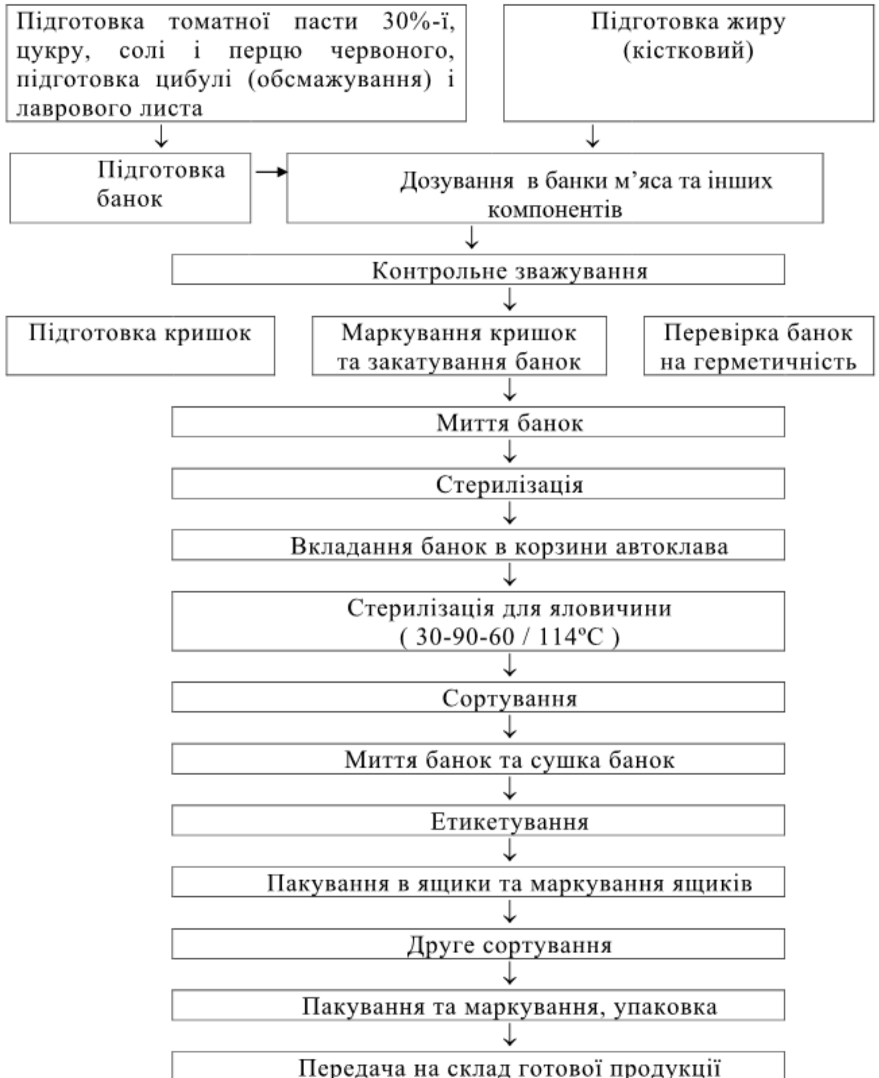
Рисунок А.4 – Технологічна схема виготовлення консервів «Тушкована яловичина в томатному соусі»
