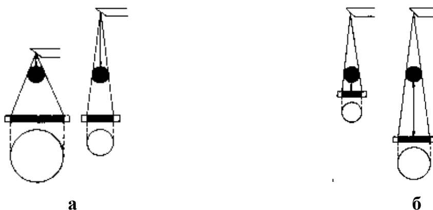
Рис.2. Залежність між відстанню фокус трубки об'єкт і проєкційним збільшенням рентгенівського зображення (а – при збільшенні фокусної відстані проєкційне збільшення рентгенівського зображення зменшується) та залежність між відстанню об'єкт-приймач зображення і проєкційним збільшенням рентгенівського зображення (б – при збільшенні відстані об'єкт-приймач зображення проєкційне збільшення рентгенівського зображення зростає)
