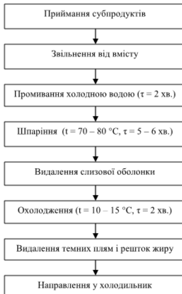
Рисунок 1.7- Технологічна схема обробки слизових субпродуктів
