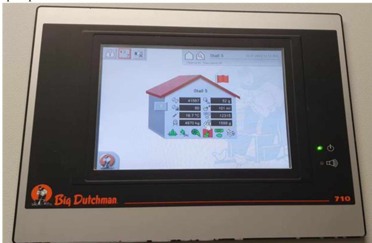
Рис. 2. Комп'ютерна система з регулювання утримання, годівлі курей-несучок
