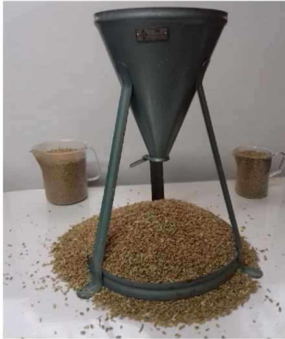
Рисунок 3.2 - Установка для вимірювання кута природного укосу зерна пшениці
