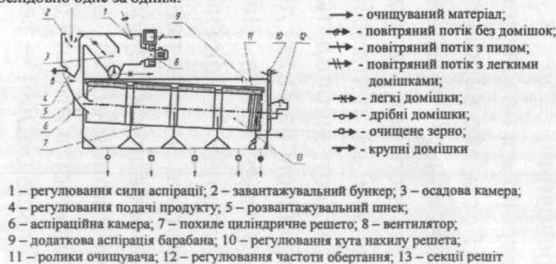
Рисунок 3 – Зерноочисна машина
