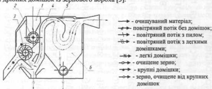
1 – бункер; 2 – живильний валик; 3 – циліндричне решето; 4 – пневмосепаруючий канал; 5 – дросель; 6 – осаджувальна камера
