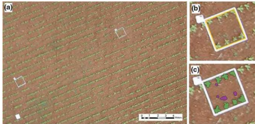
Рисунок – 1.4 Приклад отриманого БПЛА зображення поля соняшника з аналізом зображення, яке відокремлює бур'яни від соняшників
