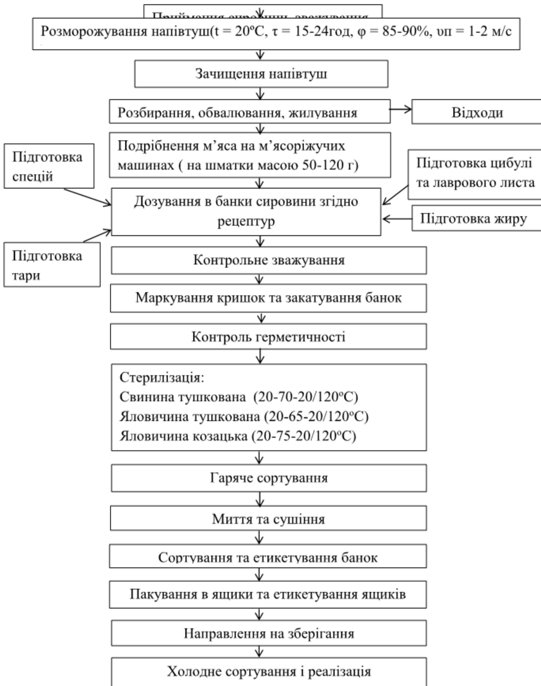
Рисунок 1.2.1 Технологічна схема виробництва натуральних консервів
