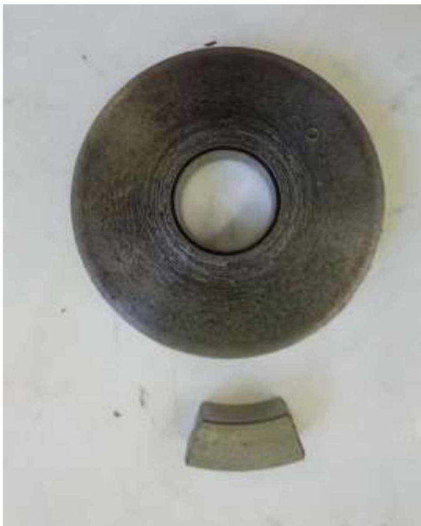
Рисунок 2.1 - Загальний вигляд пари тертя колодка-ролик
