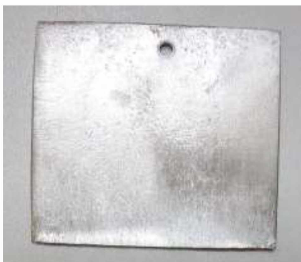
Рисунок 2.2 - Сталевий зразок для випробувань на корозійну стійкість
