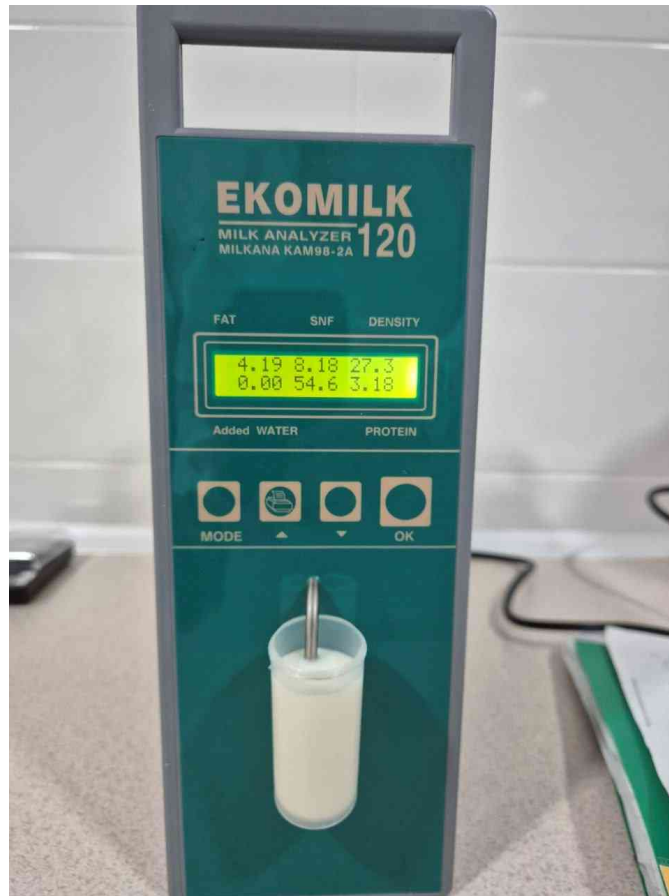
Рис. 3.1. Дослідження молока на аналізаторі «Екомілк»
