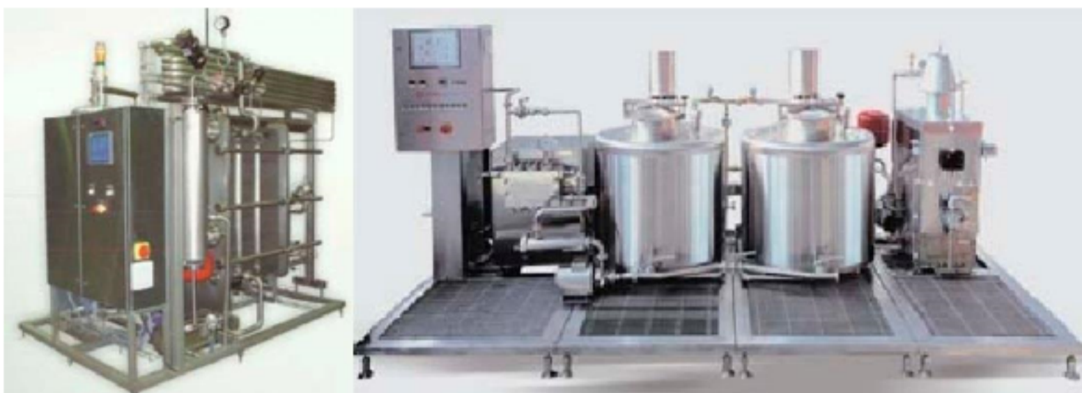
Рисунок В 1 – Пластинчастий пастеризатор і стерилізатор від Spomasz Belzyce S.A. (продуктивність до 25 000 л/год) і резервуарний пастеризатор (LTLT) від Technomix (продуктивність до 1 000 л/год)
