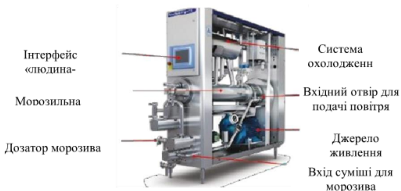
Рисунок 1.4 – Внутрішній вигляд сучасної морозильної камери для виготовлення морозива
