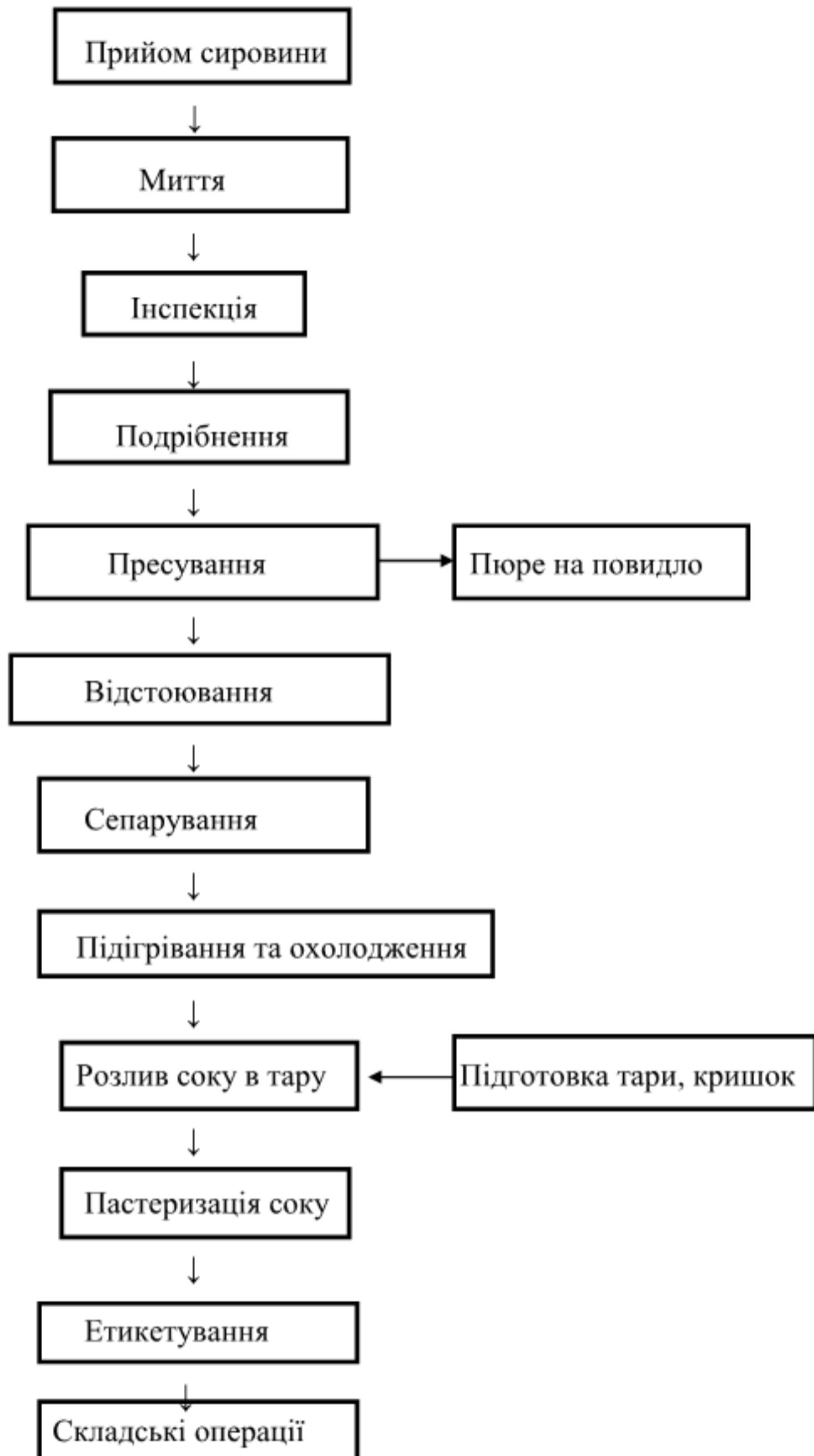
Рис 1.3. Технологічна схема виготовлення яблучного консервованого соку
