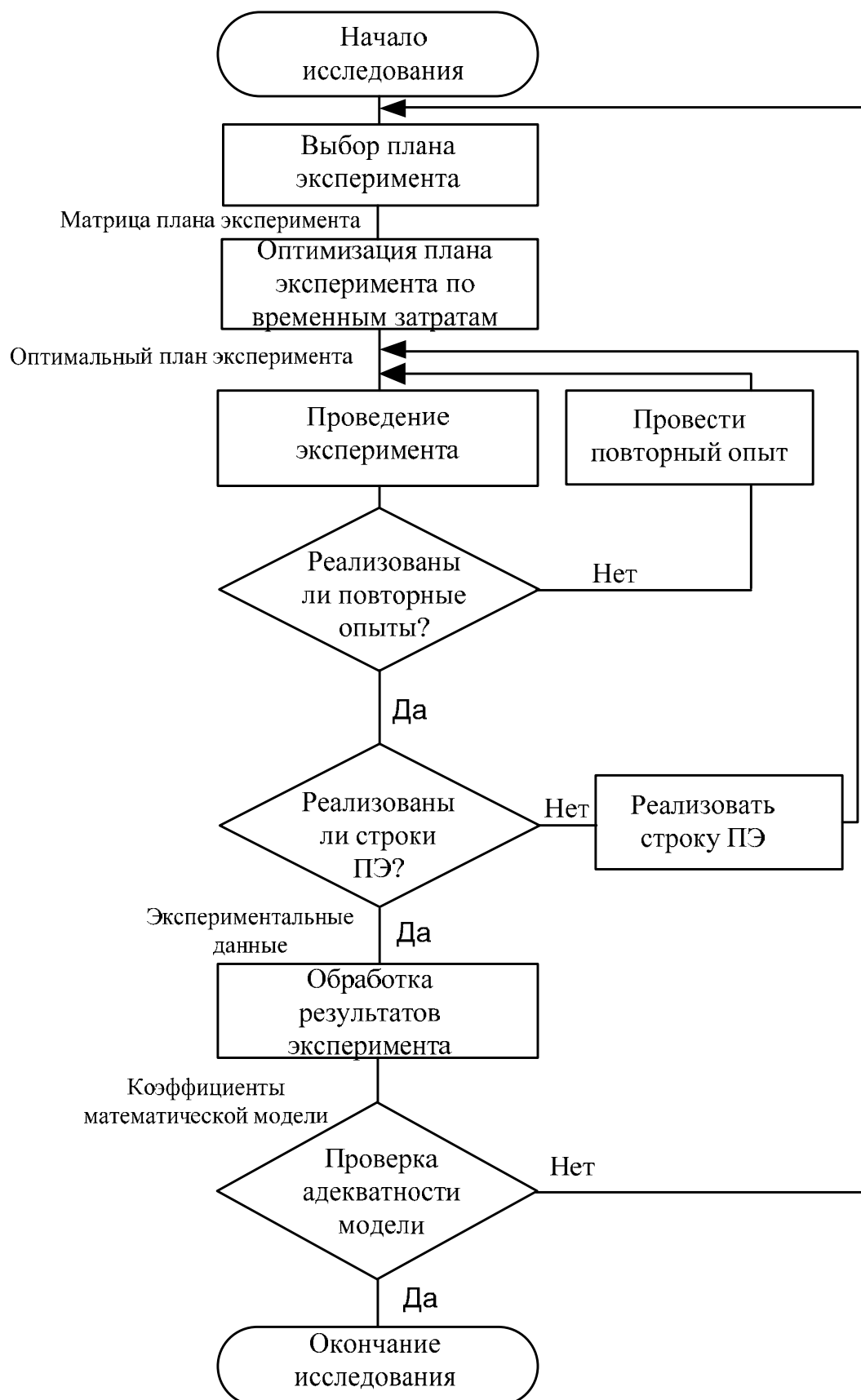
Рисунок 1.3 – Схема оптимального планирования эксперимента для исследования динамических объектов
