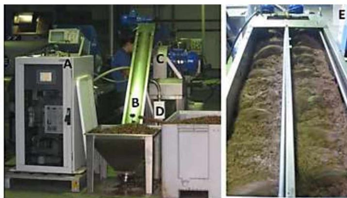
Рисунок 1.4 – Установка обробки імпульсним електричним полем оливки: А – генератор; В – транспортер; С – подрібнювач; D – камера обробки
