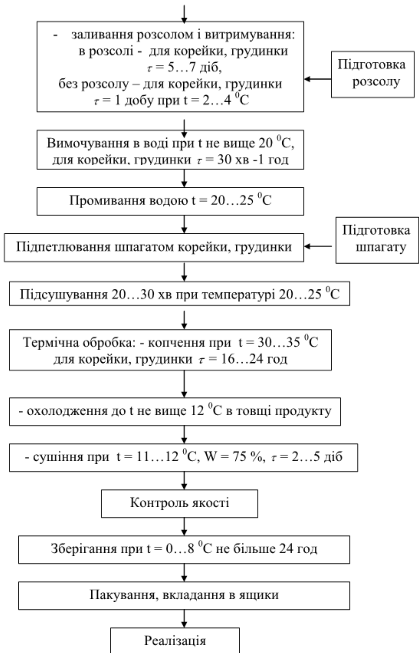
Рисунок 1.1 - Технологічна схема виробництва сирокопчених корейки та грудинки зі свинини
