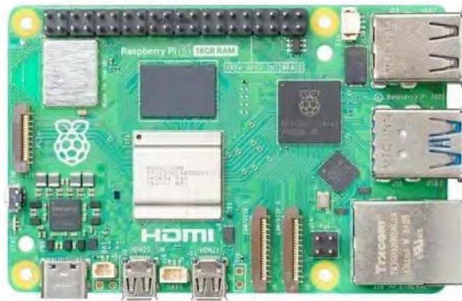
Рисунок 2.5 – SBC Raspberry Pi 5 (16GB)
