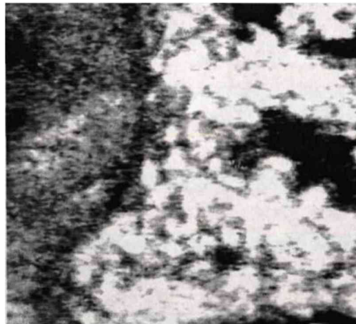
Рисунок 4.3 - Фотографія мікроструктури напеченого шару порошку марки БрАЖ 9-4 на основу з того ж матеріалу ( \times 500 ).
