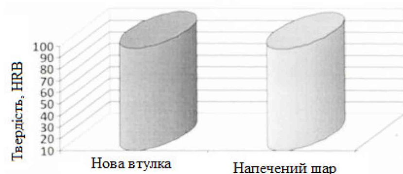
Рисунок 4.6 - Порівняння твердості напеченого шару щодо нової втулки.
