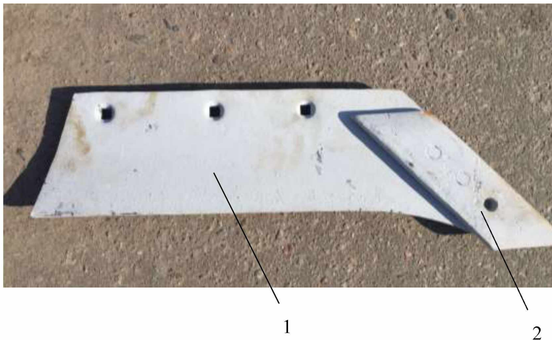
Рисунок 1.4 – Леміш зі змінними носками: 1 – корпус; 2 – носок лемішу
