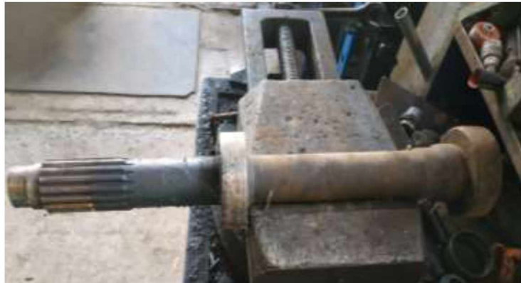
Рисунок 3.1- Зношений перехідний вал зчеплення трактора
