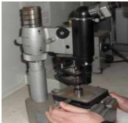
Рисунок 2.2 - Вимірювання мікротвердості на ПМТ-3
