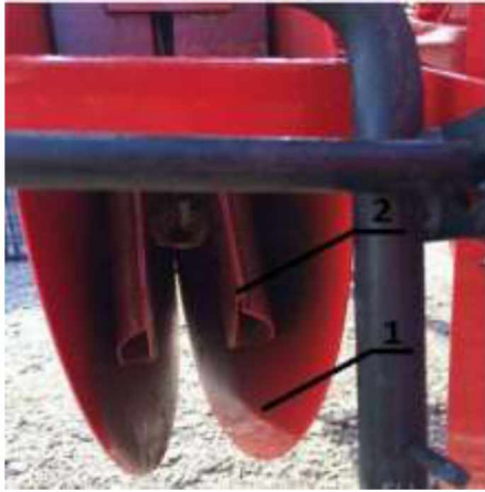
Рисунок 2.3 – Дводисковий сошник: 1 - диск; 2 - воронка ділильна
