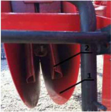
Рисунок 2.3 – Дводисковий сошник: 1 - диск; 2 - воронка ділильна
