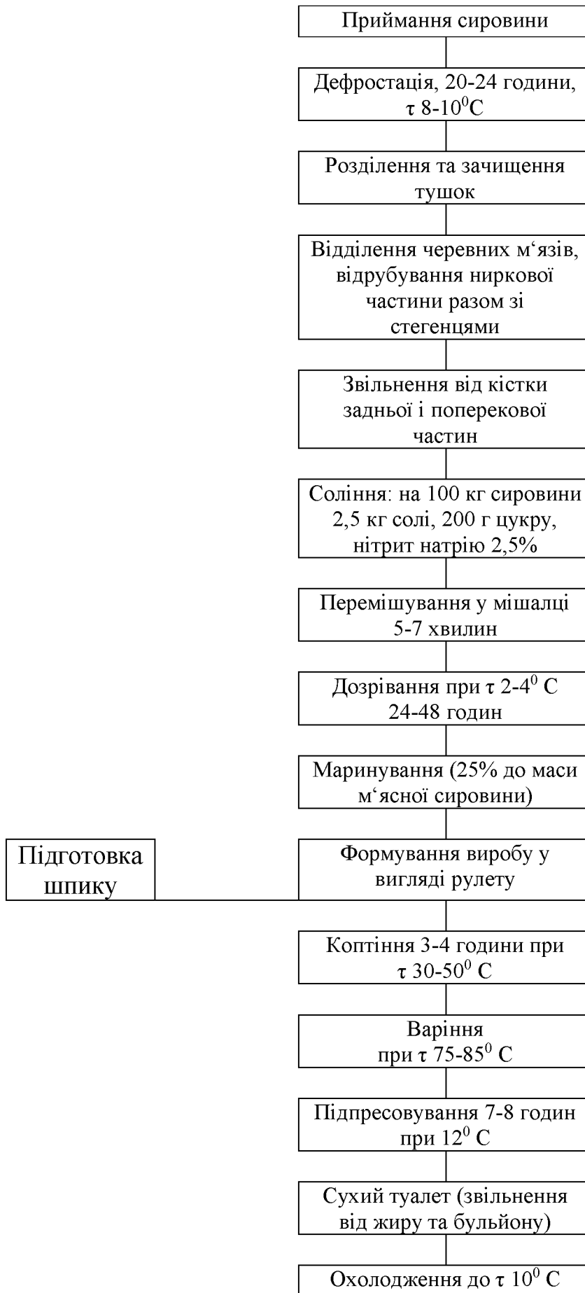
Рисунок 3.3. Технологічна схема виробництва «Рулета дієтичного»
