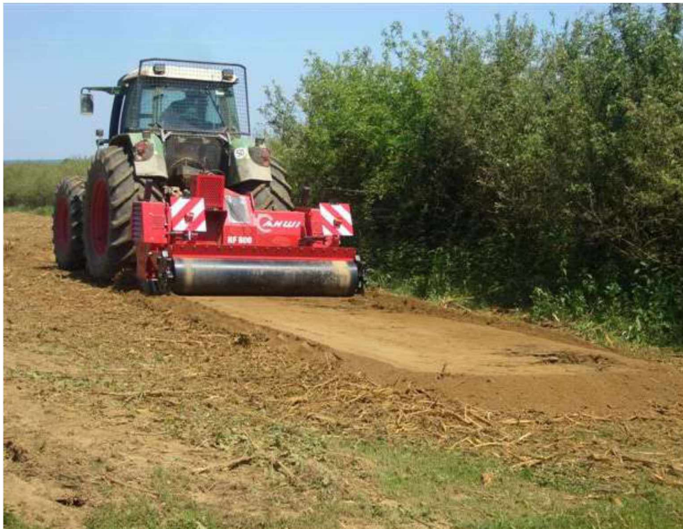
Рисунок 1.7 – Ротаватор фірми ANWI Maschbau GmbH
