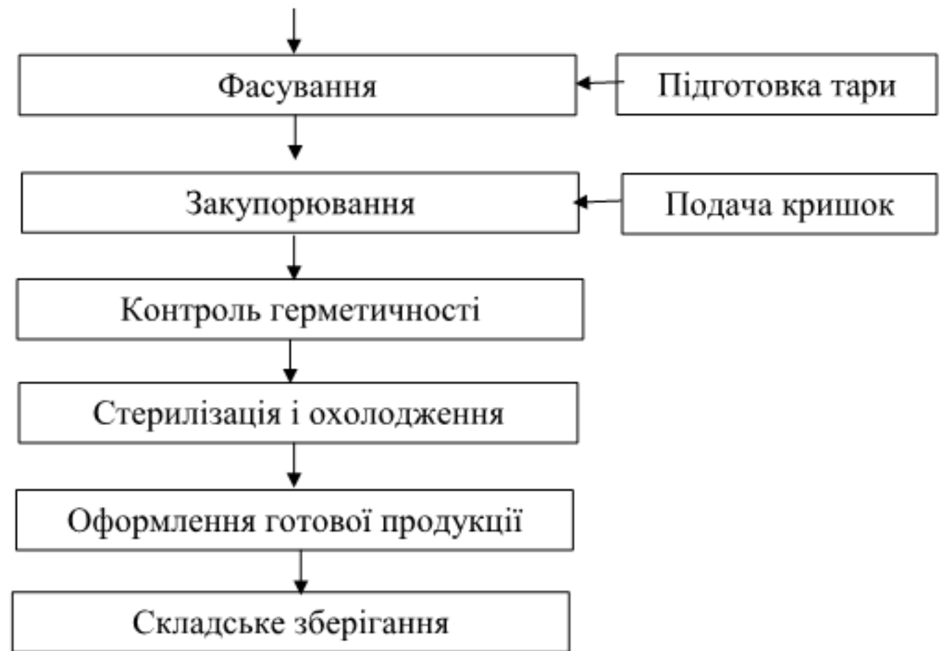
Рисунок А.3 - Технологічна схема виробництва консервів «Сік буряковий»
