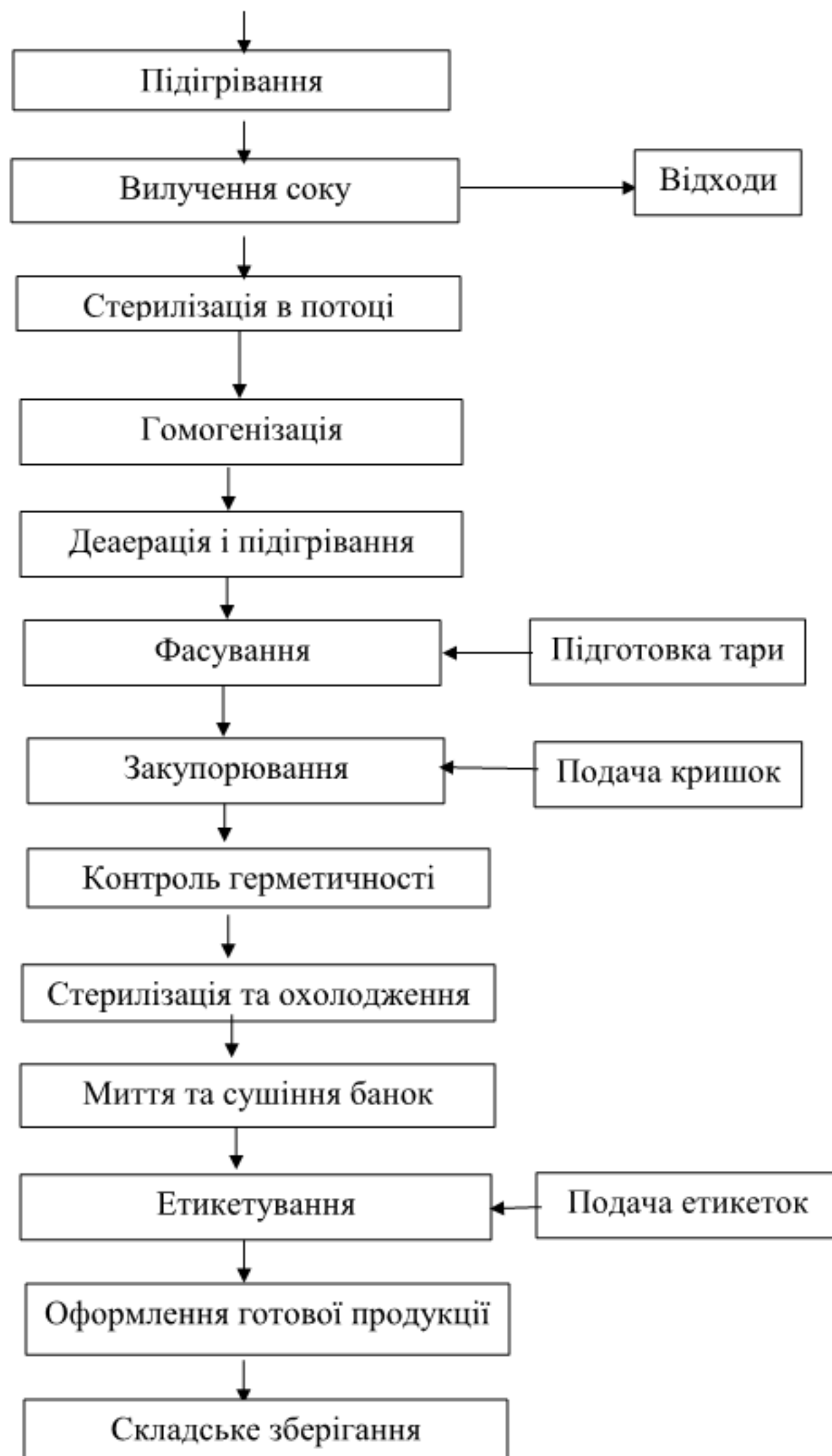
Рисунок 1.1 - Технологічна схема виробництва консервів «Сік томатний»
