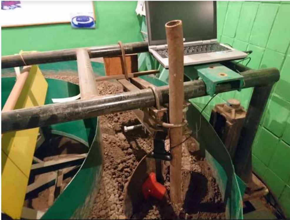
Рисунок 2.6. – Кріплення диска із стійкою та вимірювальної апаратури на установці
