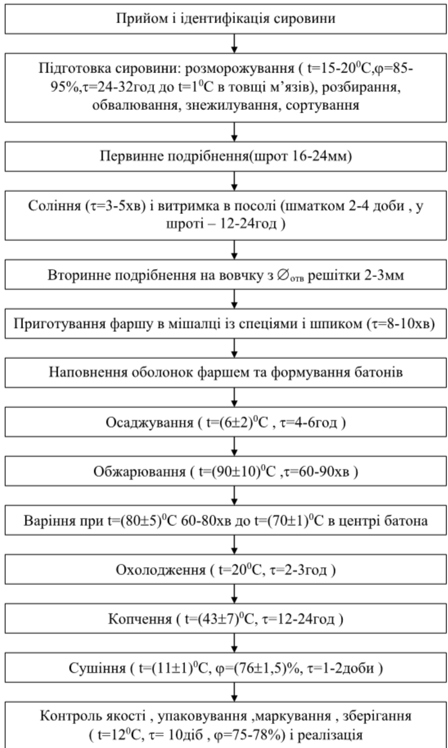
Рисунок 1.2. -Технологічна схема виробництва напівкопчених ковбас
