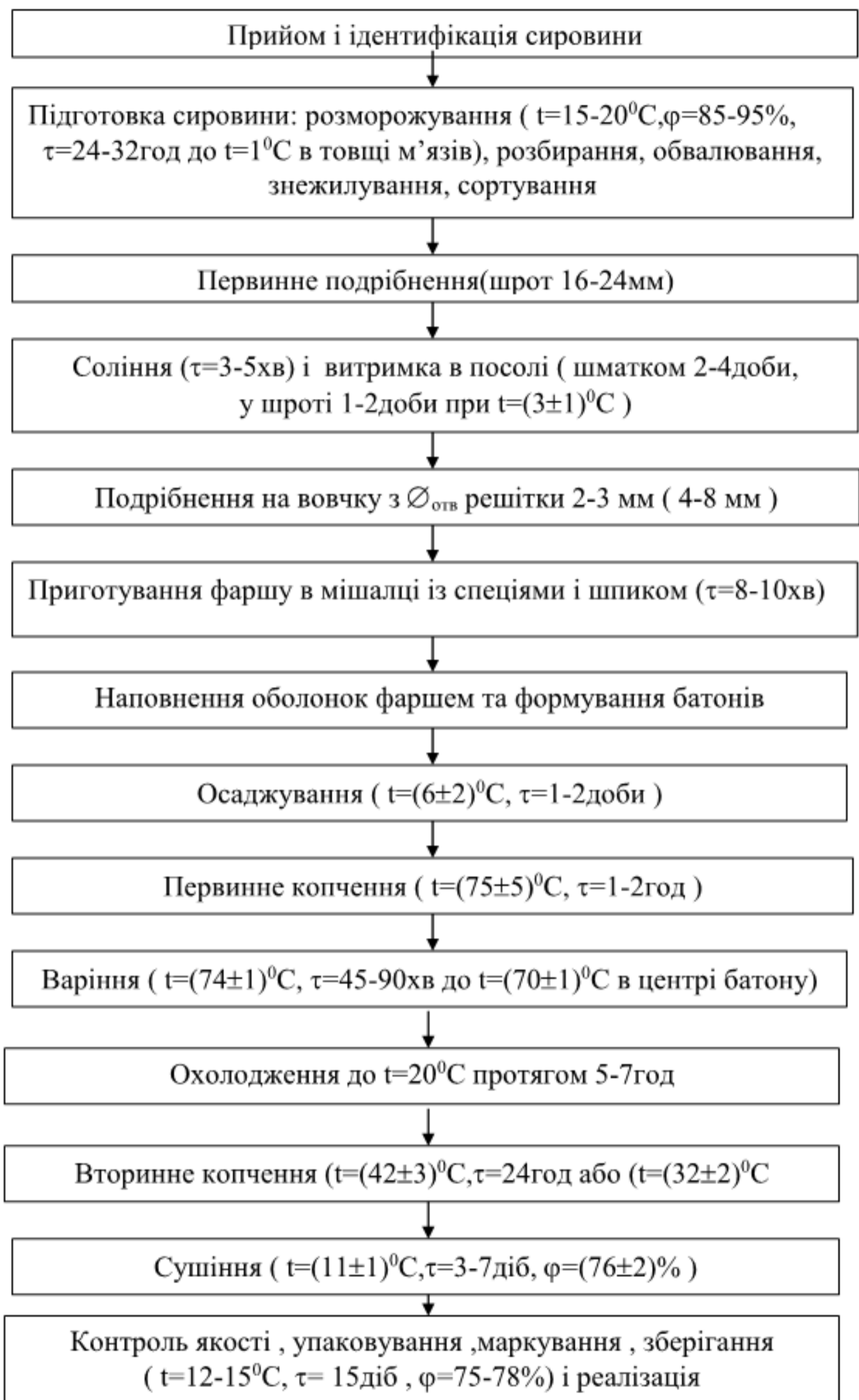
Рисунок 1.3. - Технологічна схема виробництва варено-копчених ковбас
