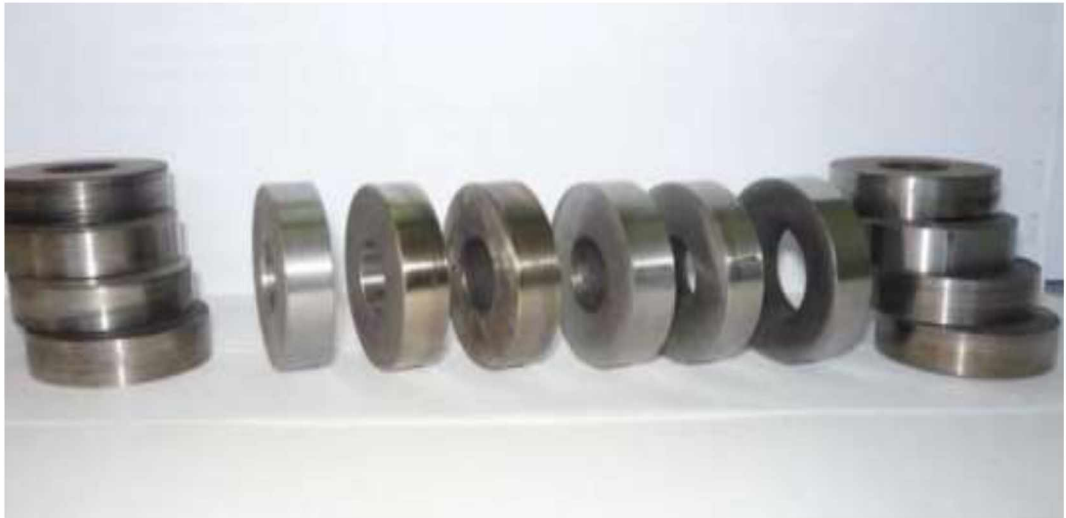
Рисунок 2.6 – Зразки для дослідження впливу трибоматеріалів в складі оливи на величину зносу
