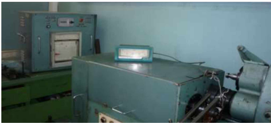
Рисунок 2.5 – Машина тертя СМЦ-2
