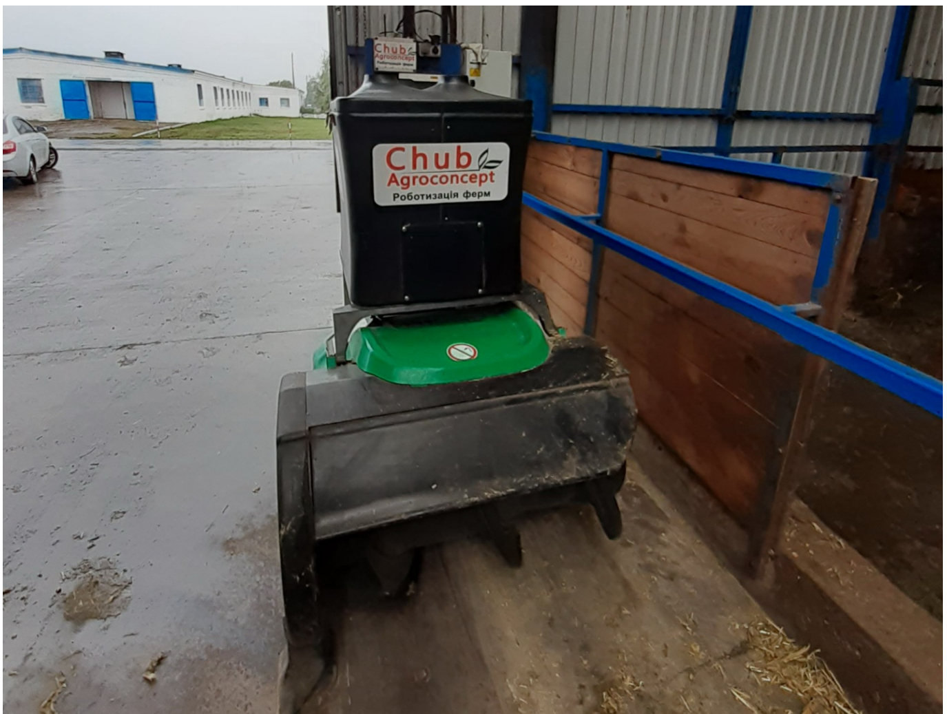
Рис. 3.8. Робот-підгортач Butler Gold
