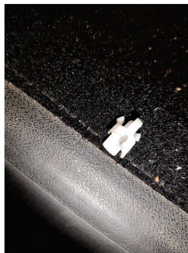
Рисунок 2 – Елементи з'єднання педалі зчеплення зі штоком: а – розімкнене положення з'єднання; б – пластикова втулка зі зламною третьою пелюсткою; в – зовнішній вигляд пластикової втулки
