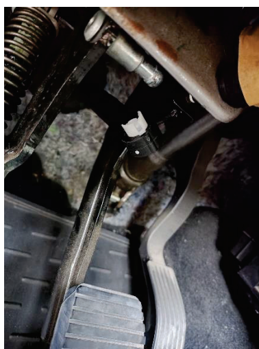
Рисунок 2 – Елементи з'єднання педалі зчеплення зі штоком: а – розімкнене положення з'єднання; б – пластикова втулка зі зламною третьою пелюсткою; в – зовнішній вигляд пластикової втулки
