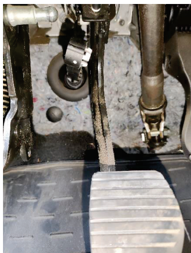
Рисунок 2 – Елементи з'єднання педалі зчеплення зі штоком: а – розімкнене положення з'єднання; б – пластикова втулка зі зламною третьою пелюсткою; в – зовнішній вигляд пластикової втулки
