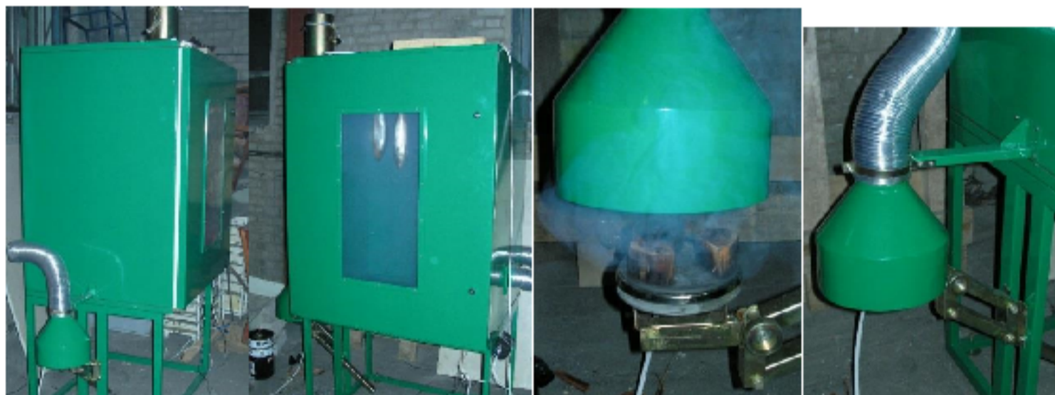
Рисунок 1.9 – Автономна коптильна установка електростатичної дії
