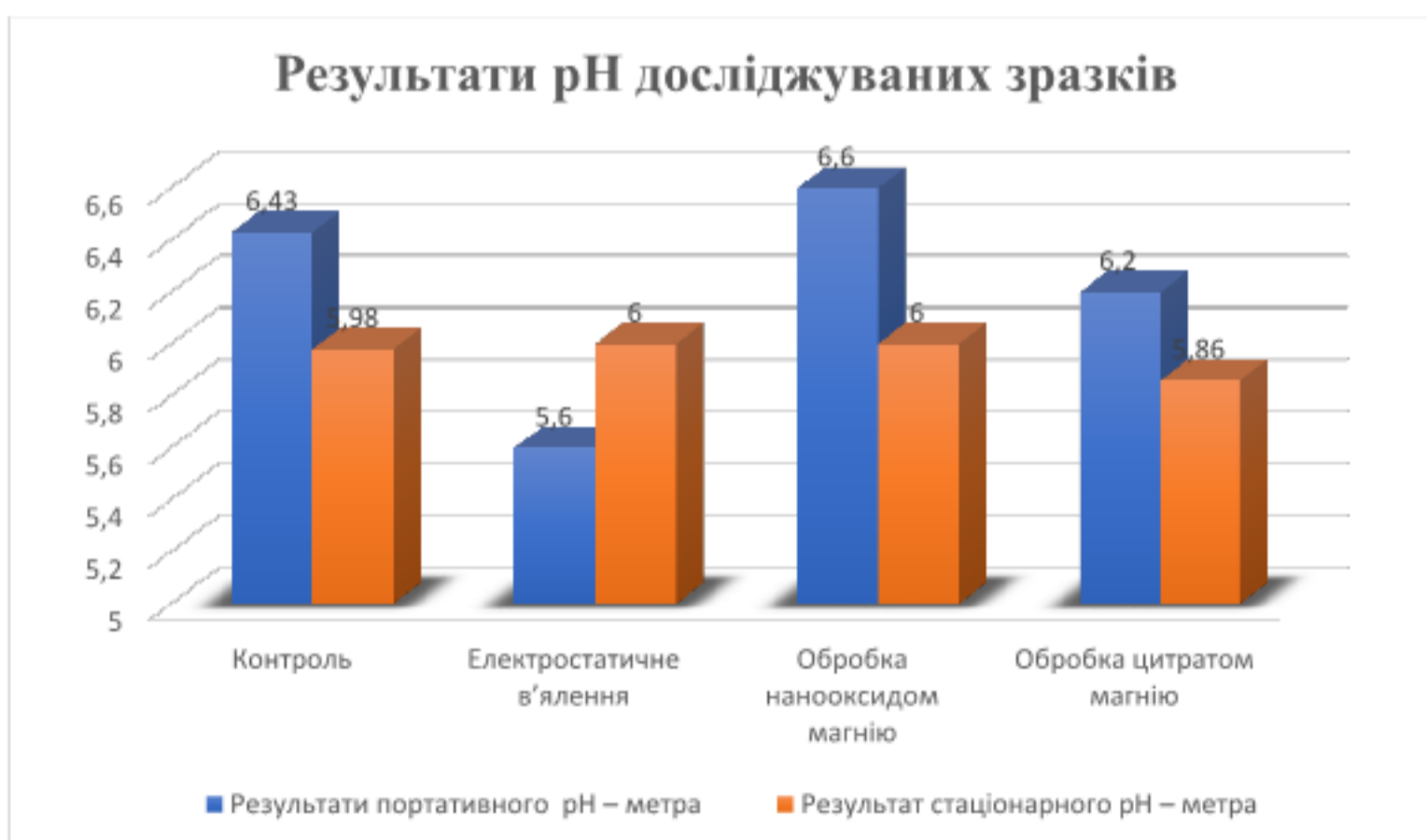
Рисунок 3.12 – Результати електростатичного в'ялення в порівнянні з іншими видами обробки
