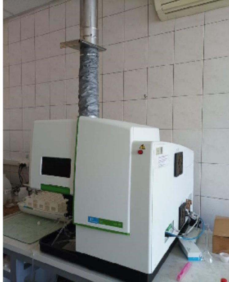
Рис. 2.3. Оптико-емісійний спектрометр з індуктивно-зв'язаною плазмою Avio 200
