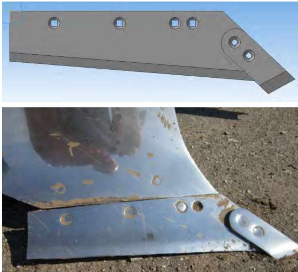
Рисунок 3.1 – Леміш з прямим паралельно встановленими до борозни обрізу долотом
