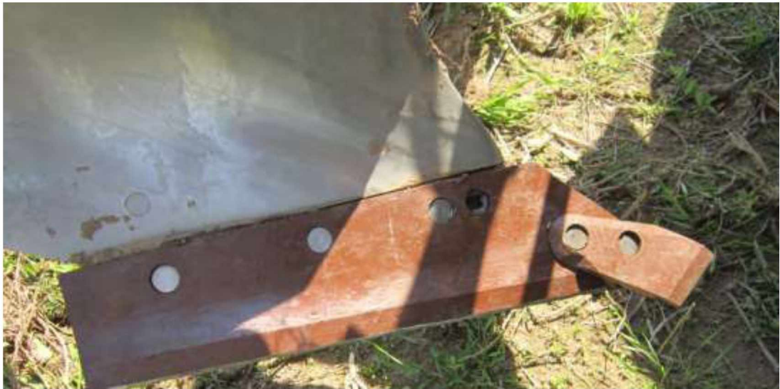
Рисунок 3.2 – Леміш з нахиленим долотом до борозни обрізу
