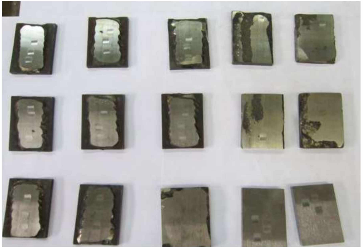
Рисунок 2.5 - Зразки, що випробовувалися на машині тертя ІМ-01, на абразивну зносостійкість
