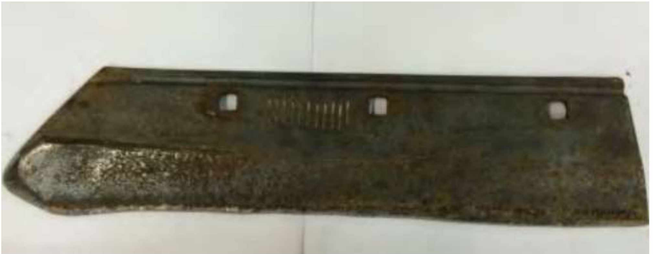
Рисунок 3.9 - Загальний вигляд не працездатного серійного лемеша, виготовленого зі сталі Л53 з індукційним наплавленням після напрацювання 3,5 га на корпус у важких ґрунтових умовах
