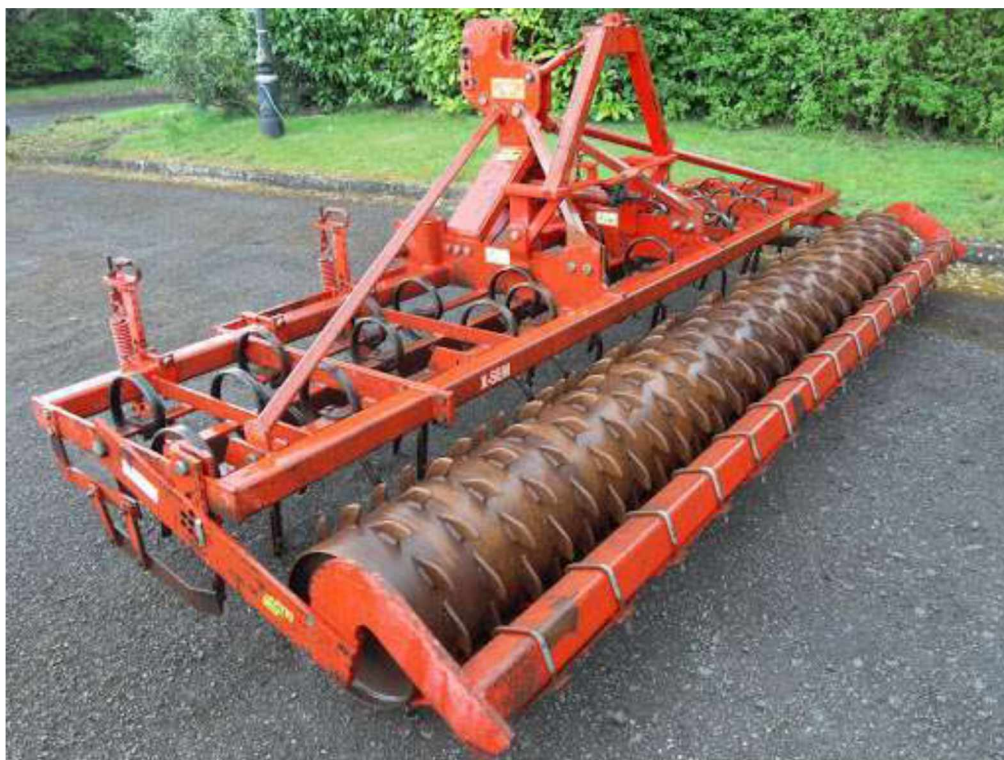
Рисунок 1.1. – Комбінований агрегат для передпосівного обробітку ґрунту фірми RAU (перший варіант комплектації)
