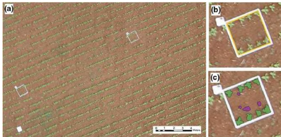
Рисунок 1.8 – Приклад отриманого UAV зображення поля соняшника з аналізом зображення, яке відокремлює бур'яни від соняшників
