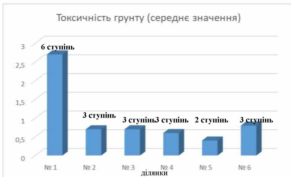
Рис. 3.4 – Ступінь токсичності ґрунту несанкціонованого звалища ТПВ
