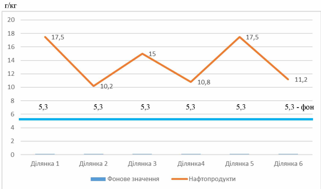
Рис. 3.3 - Вміст нафтопродуктів у ґрунті несанкціонованого звалища ТПВ
