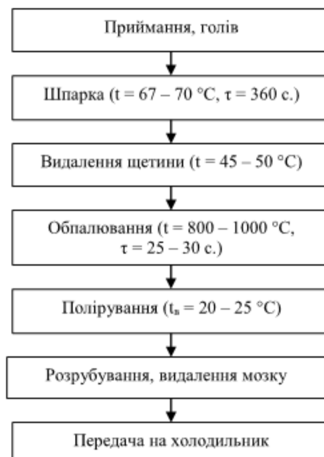
Рисунок 1.10 - Технологічна схема обробки свинячих голів
