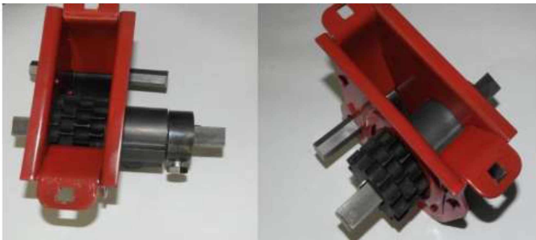
Рисунок 3.7 – Загальний вигляд котушкового висівного апарату з чотирьохсекційною котушкою, жолобки якої виконані у формі частини тора
