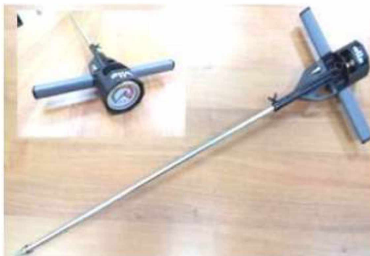
Рисунок 2.3 – Загальний вигляд твердоміра ґрунту Wile Soil
