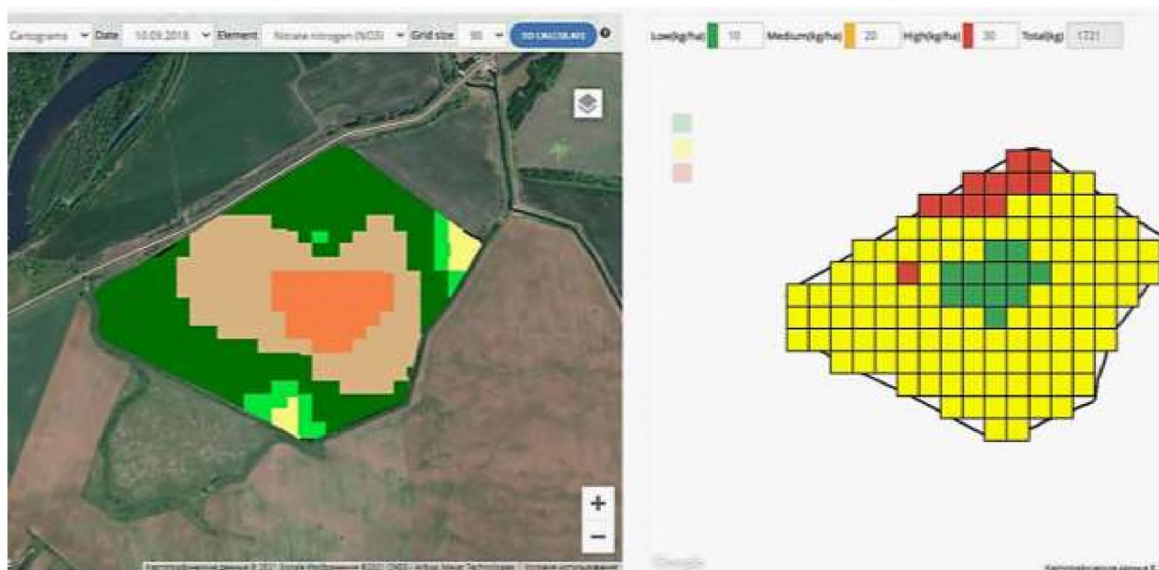
Рисунок 2.7 – Результати хімічного аналізу поля (зліва) по концентрації поживних речовин та технічне завдання по диференційованому внесенню добрив (справа) в IC Soft.Farm
