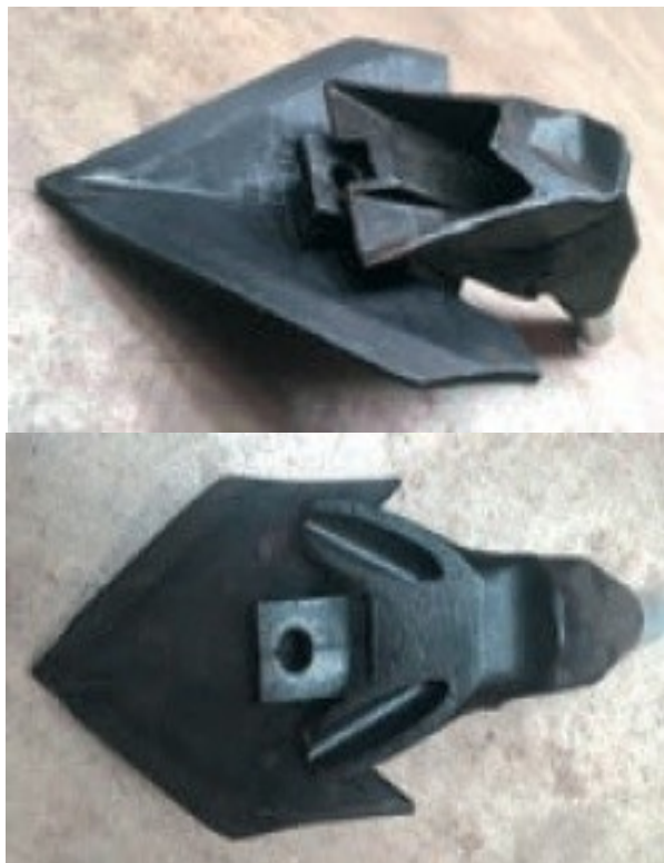
Рис. 6. Лапи агрегату Claydon Hybrid-T4 для одночасного розпушування ґрунту, сівби та внесення добрив у зону висіву насіння
