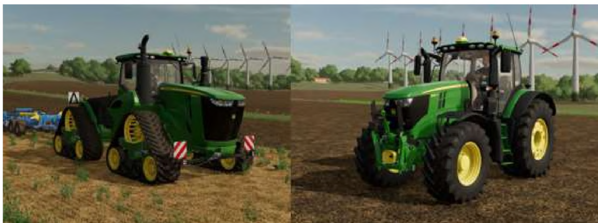
Рисунок 1.1 – Колісний та гусеничний варіанти тракторів
