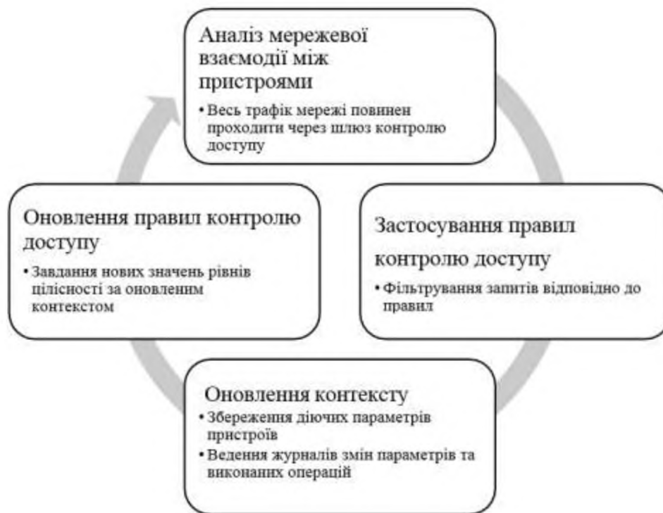
Рисунок 2.5 – Процес функціонування системи контролю доступу розумного будинку
