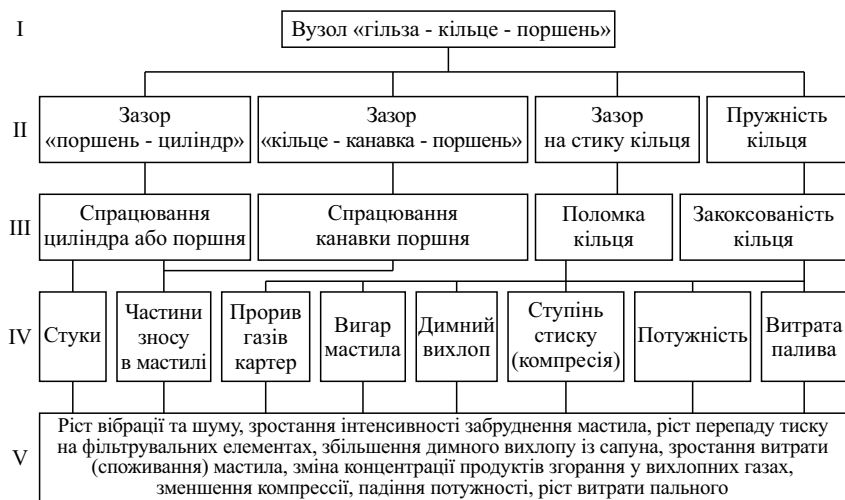
Рисунок 9.5 – Параметри структурно-діагностичної схеми (на прикладі поршиєвої групи двигуна внутрішнього згорання)
