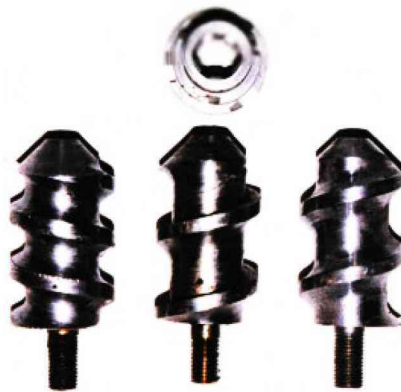
Рисунок 3.7 – Різні конструкції закінчення шнека, що застосовувалися при дослідженнях
