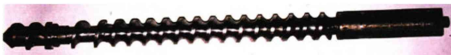
Рисунок 3.2 – Робочий орган (шнек № 1) шнекового прес-екструдера з змінним кроком витка, шириною лопаті b = 0,007 мм та дросельним елементом
