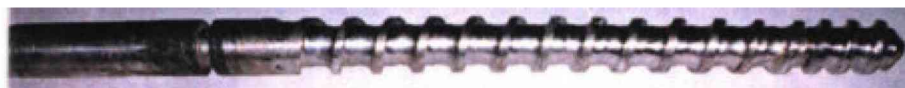
Рисунок 3.3 – Робочий орган (шнек № 1) шнекового прес-екструдера з кроком витка t = 0,040 мм, шириною лопаті b = 0,008 мм
