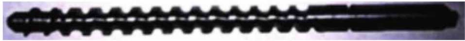
Рисунок 3.5 - Робочий орган (шнек № 4) шнекового прес-екструдера з кроком витка t = 0,040 мм, шириною лопаті b = 0,013 мм
