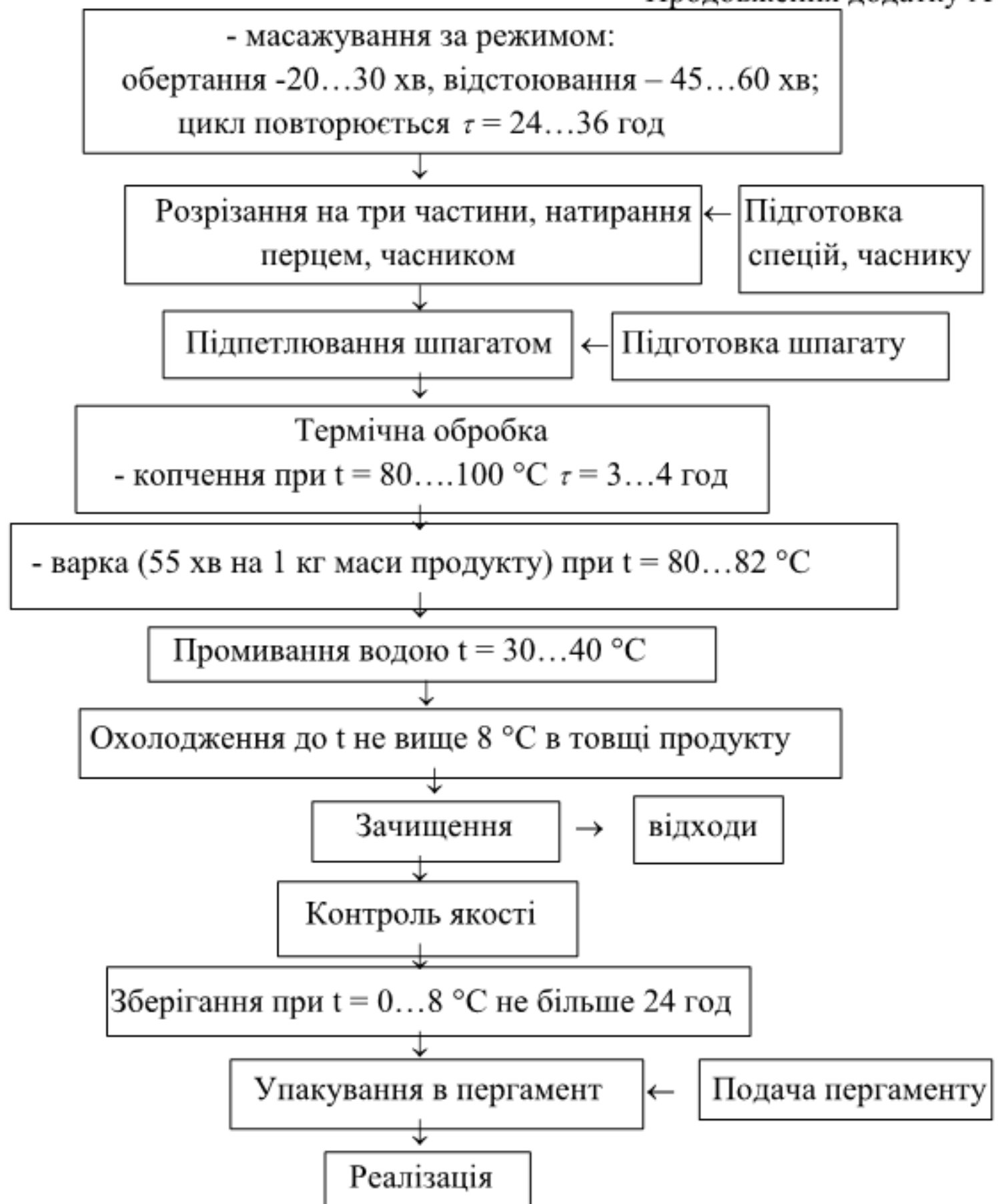
Рисунок А.2 - Технологічна схема виробництва копчено-вареної шинки по білоруські зі свинини
