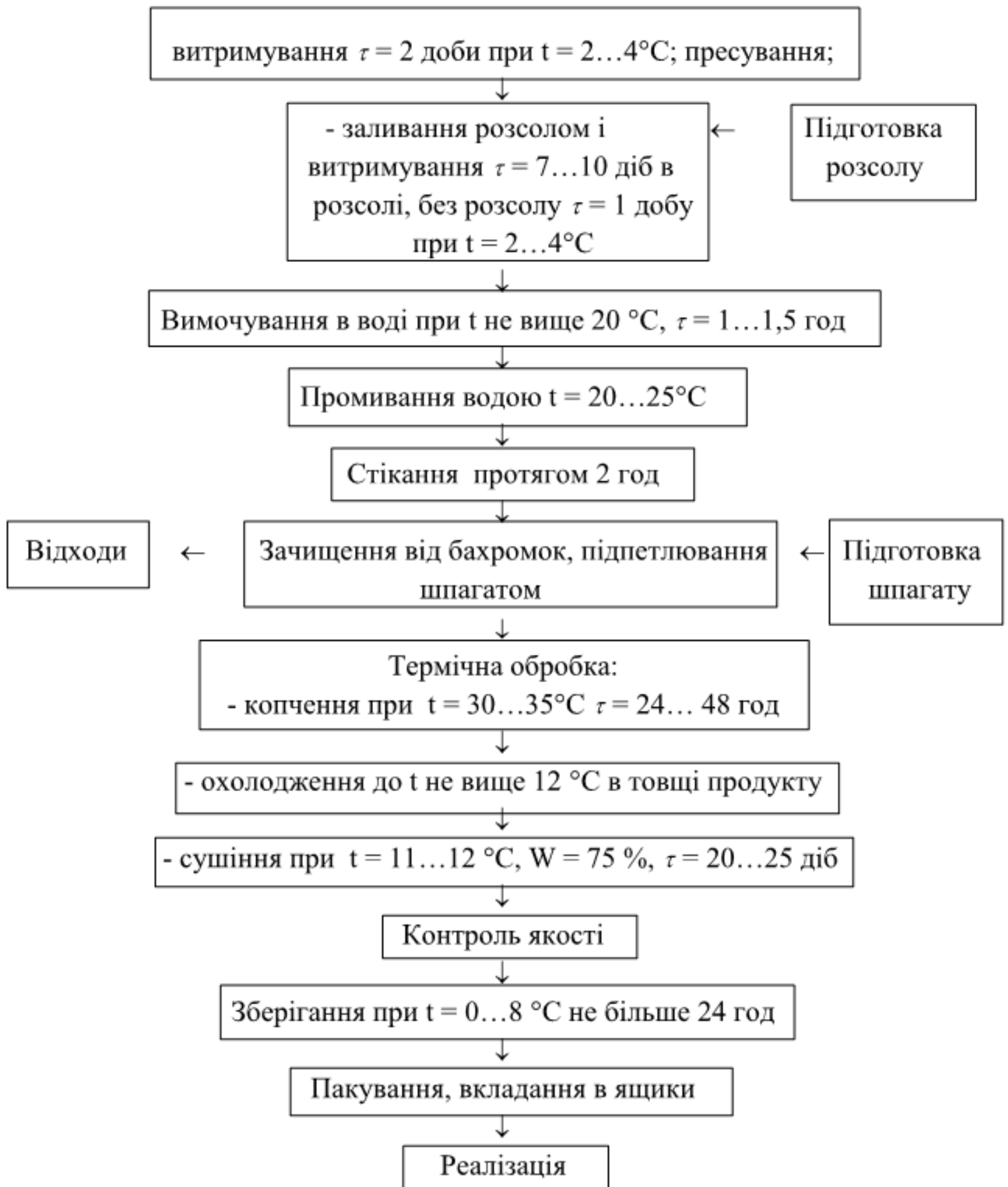
Рисунок А.4 - Технологічна схема виробництва сирокопченої шийки ветчинної зі свинини
