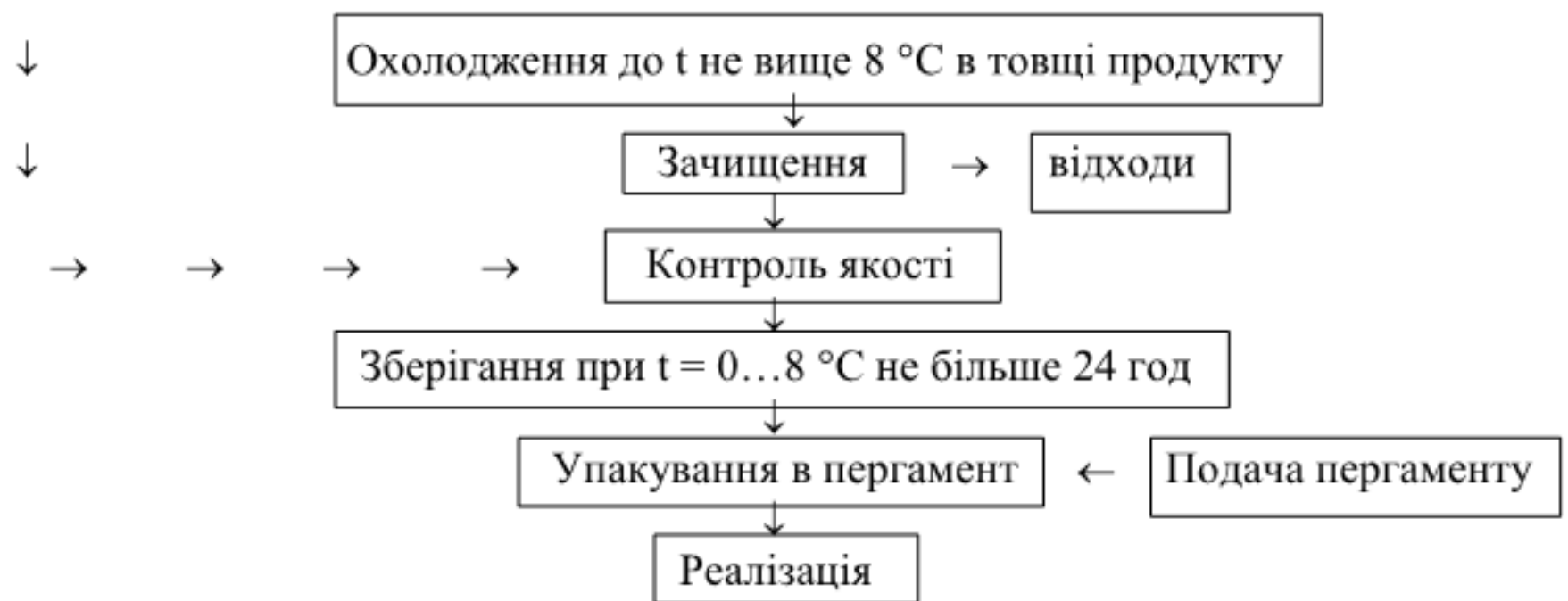
Рисунок 1.1 - Технологічна схема виробництва варених продуктів із свинини [6]
