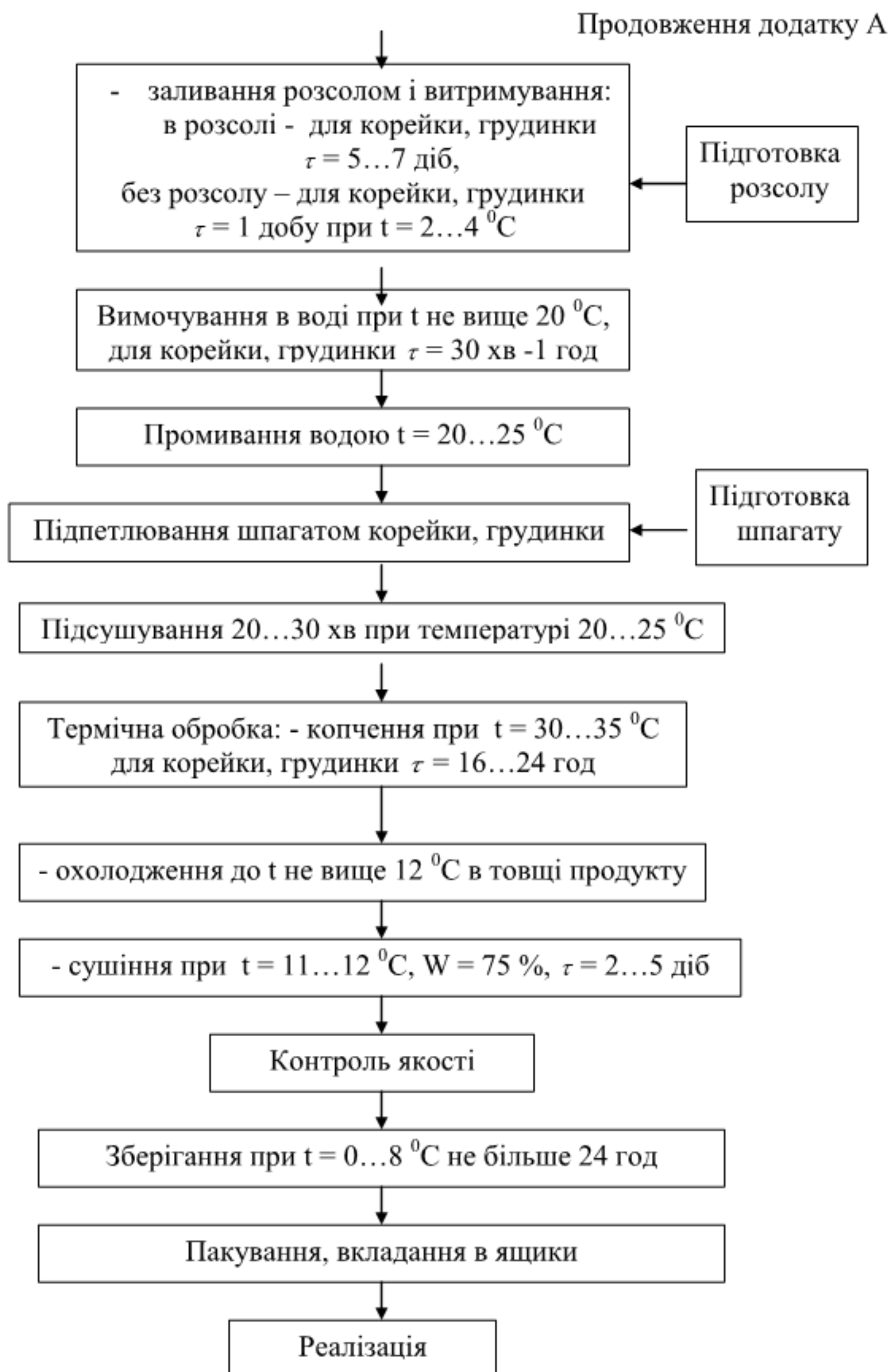
Рисунок А.5 - Технологічна схема виробництва сирокопчених корейки та грудинки зі свинини
