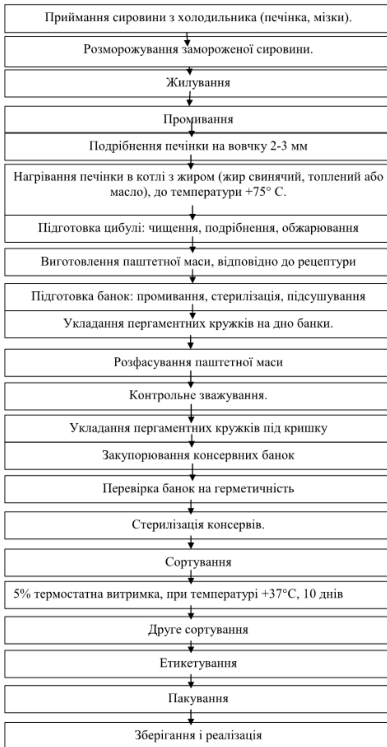
Рис. 1.3. Технологічна схема вироблення консервів «Паштет печінковий»
