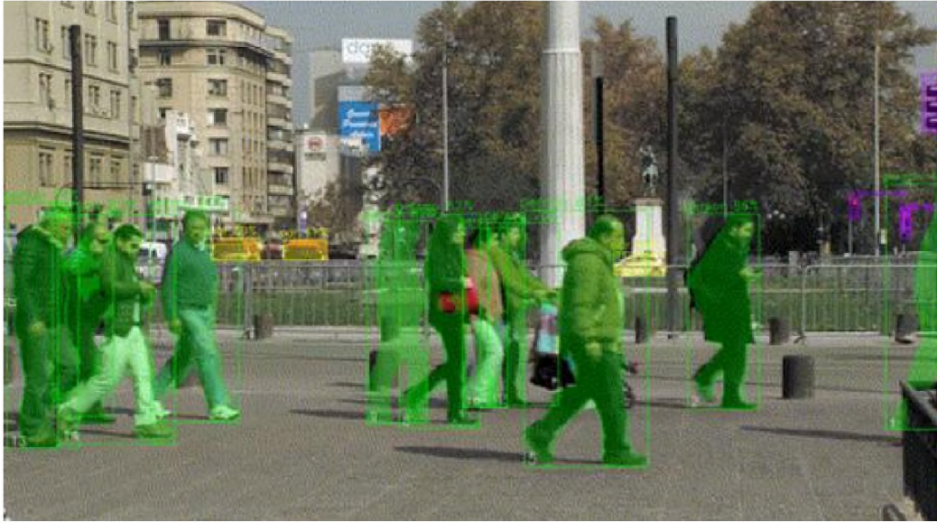
Рисунок 3.9 – Instance segmentation за допомогою акселератору ШІ Nailo-8
