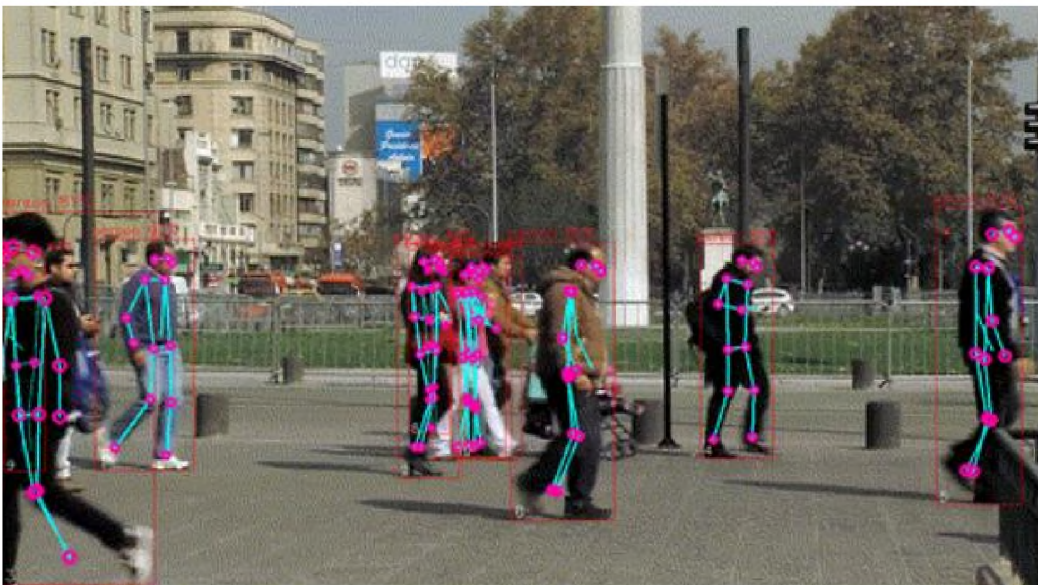
Рисунок 3.10 – Pose estimation за допомогою акселератору ШІ Nailo-8
