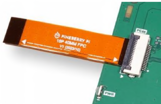
Рисунок 3.6 – Орієнтація стрічкового кабелю інтерфейсу PCIe
