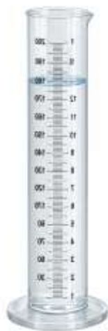
Рис. 2.1. Мірний циліндр з лінійкою
